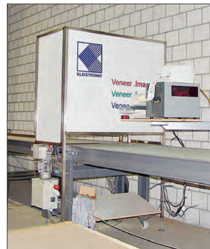
Mit dem 2012 neu erworbenen „Veneer-Imager“ von Kleistronik werden die Oberflächen aller Furnierpakete digital erfasst und sind jederzeit abrufbar
