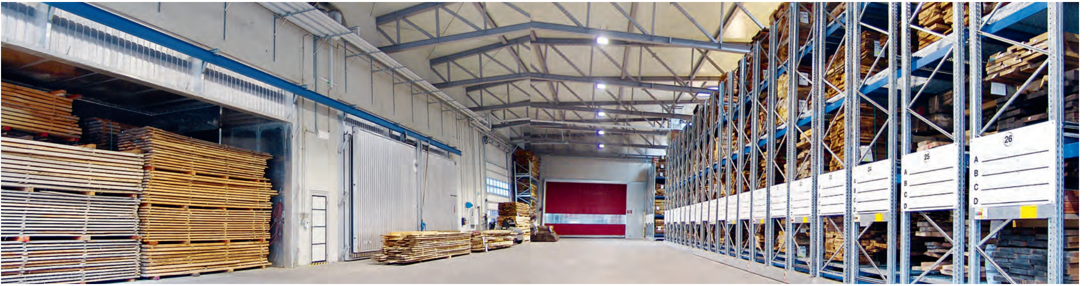
Bis zu 3000 m 2 Schnittholz fasst die neue, voll klimatisierte Lagerhalle in 27 beweglichen, 6,5 m hohen Hochregallagern. Integriert sind zwei Frisch- und Ablufttrockner (links).
