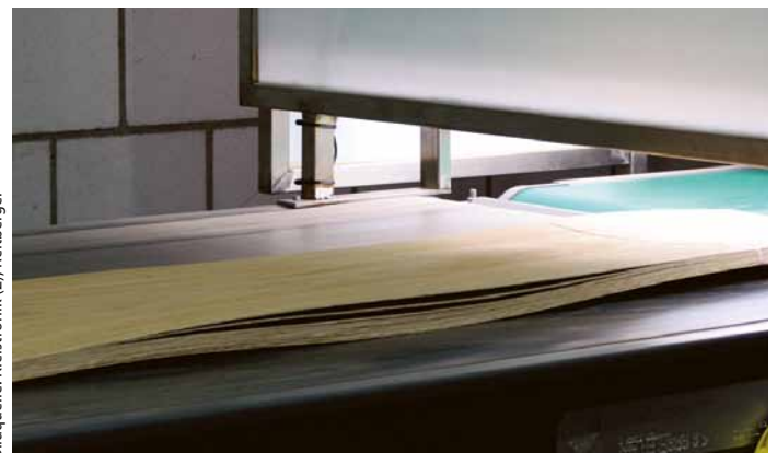
Bei bis zu 40 m/min schießt der Veneer-Imager vier Aufnahmen pro Millimeter, welche anschließend von einer Software zu einem digitalen Bild zusammengefügt werden
